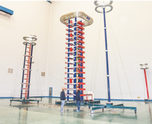
变压器实验室内的超高压发生器
