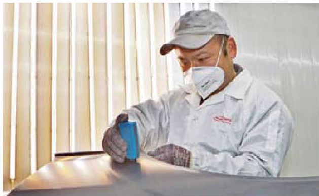
公司技术人员使用稀金修复奔驰汽车车身件
