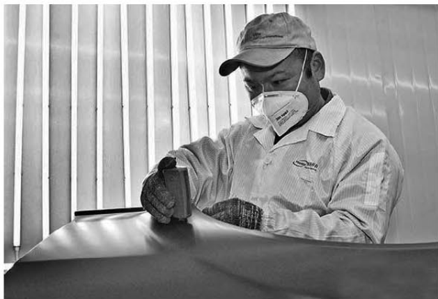
公司技术人员使用稀金修复奔驰汽车车身件
