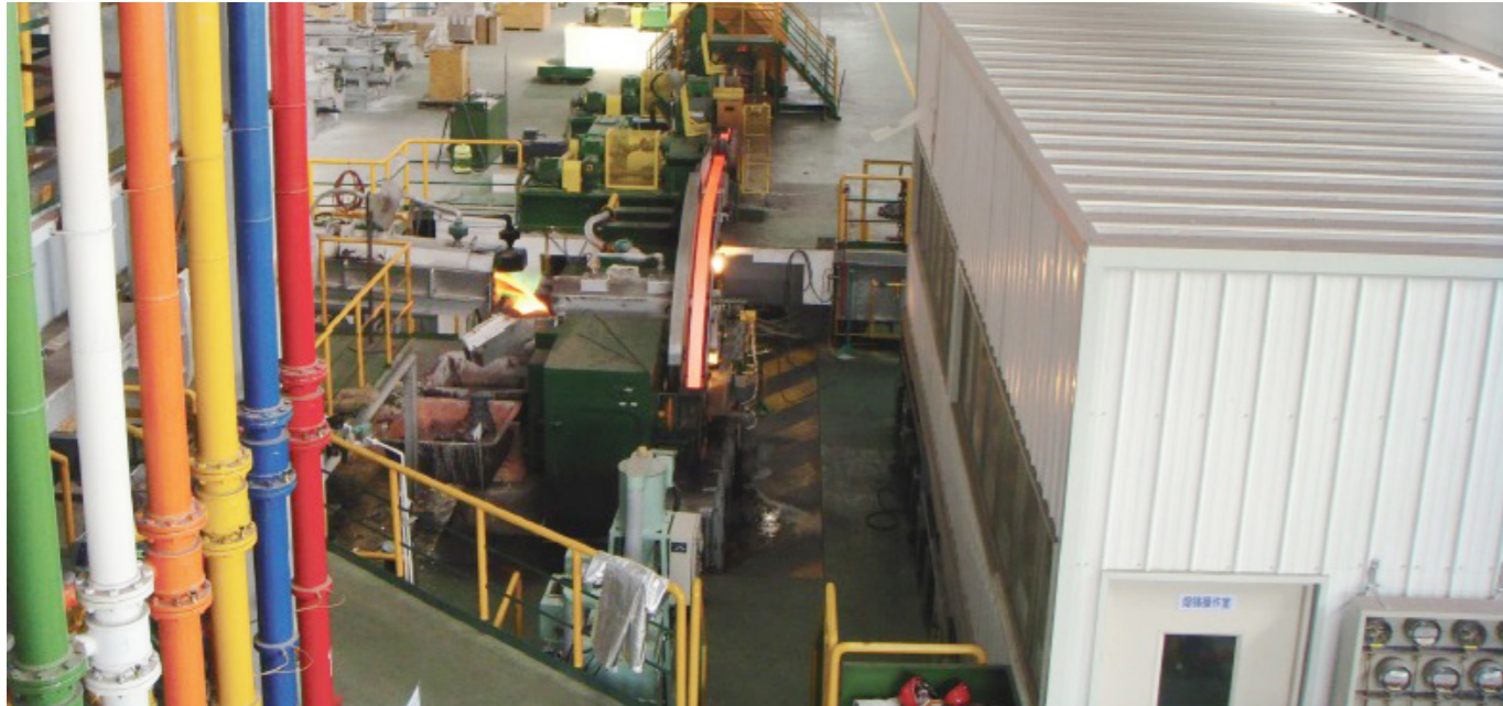
金源铜业 SCR 轮式浇铸生产线
